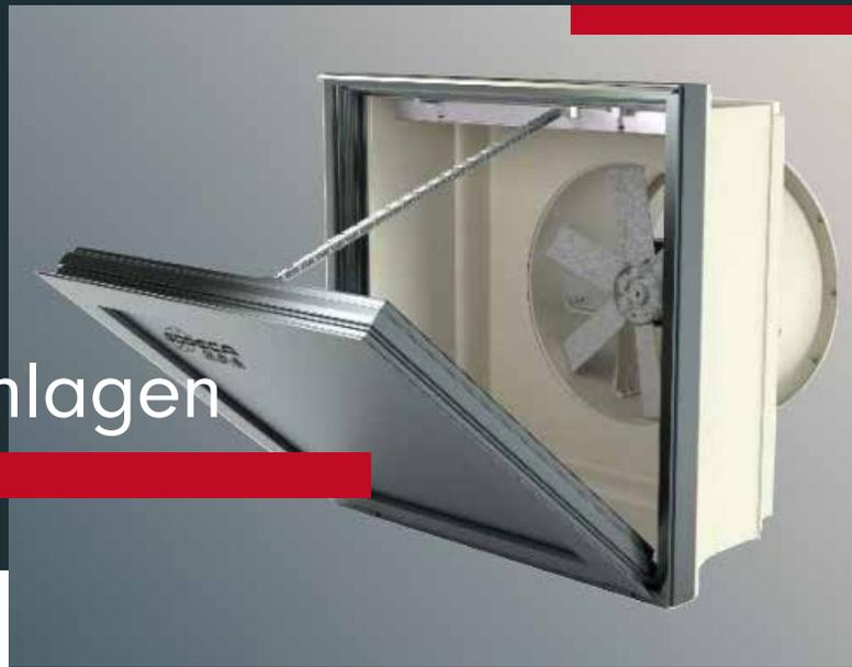
Mechanische Rauch- und Wärmeabzugsanlagen mit Wandventilatoren (MRA-W) sorgen für eine gezielte Ableitung von Rauch und Hitze über die Fassadenstruktur. Sie sind eine kompakte und leistungsstarke Lösung, insbesondere für Gebäude mit begrenztem Platzangebot auf dem Dach oder mit spezifischen baulichen Anforderungen. Durch die platzsparende Montage an der Wand ermöglichen MRA-W-Systeme eine effiziente Entrauchung und tragen entscheidend zur Sicherheit von Personen und Sachwerten bei.
